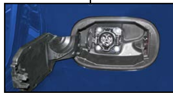
Prise de charge haute tension
