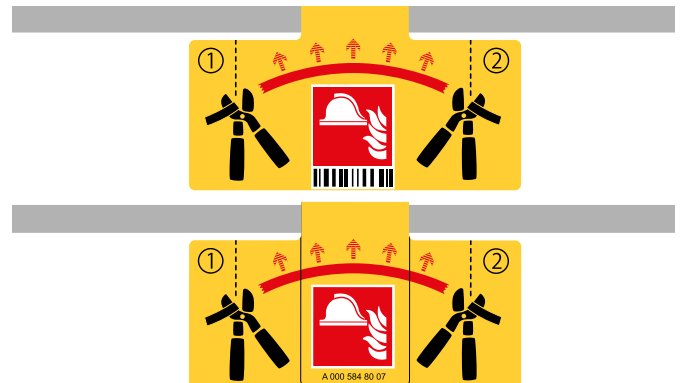
Plaquette d'information dispositif de coupure haute tension de remplacement
