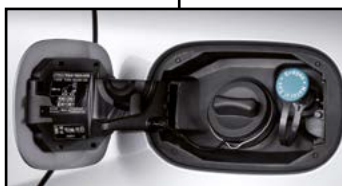
Tubulure de remplissage de gaz naturel
