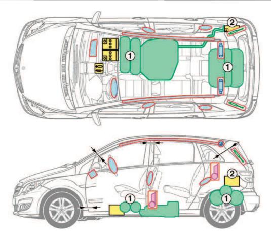
1 réservoir à gaz 2 batterie additionnelle sur les modèles BlueEFFICIENCY
