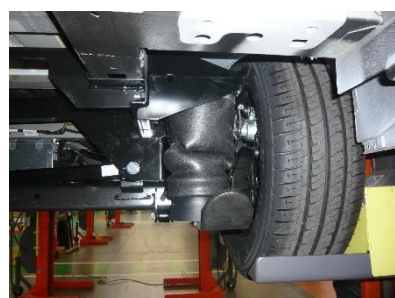
Suspensions pneumatiques asservies à la manœuvre de la rampe lorsqu'elle est électrique (variations de garde au sol).
