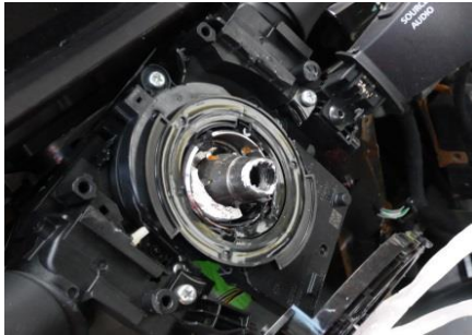
Colonne de direction creuse, sécable en arrière du volant.
