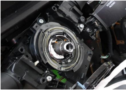
Colonne de direction creuse, en arrière du volant.
